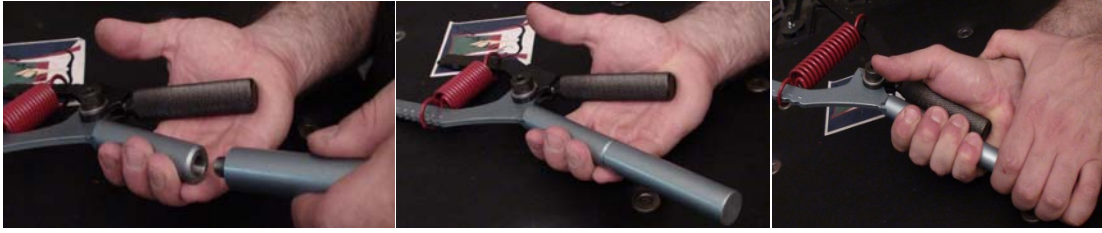
Kabza uzatması montajı ve kabza uzatması yardımı ile bir üst kademeden sıkılması
