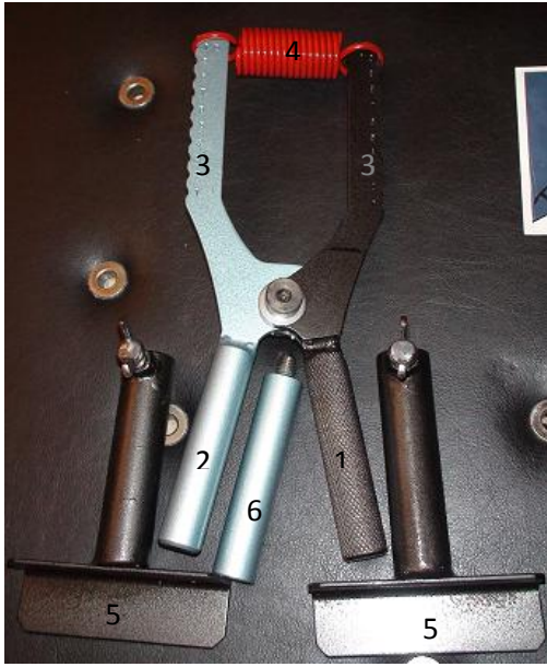
Kerpeten ve Eklentileri: 1-Tırtırlı Kabza, 2-Düz Kabza, 3-Çentikli kollar, 4-Çeki Yay, 5-Pense eklentisi, 6-Negatif-statik çalışma uzatması
